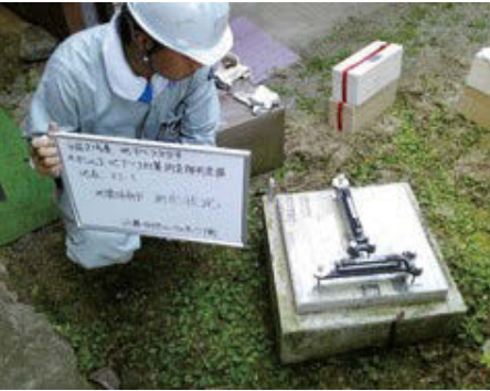
地すべり対策調査 地盤傾斜計による傾斜変状の調査と、地すべり挙動の把握
